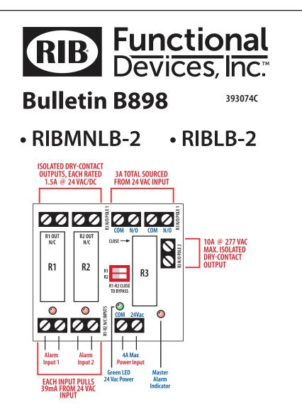
**CAUTION:** RISK OF ELECTRIC SHOCK - MORE THAN ONE DISCONNECT MAY BE REQUIRED TO DEENERGIZE THE DEVICE BEFORE SERVICING.
